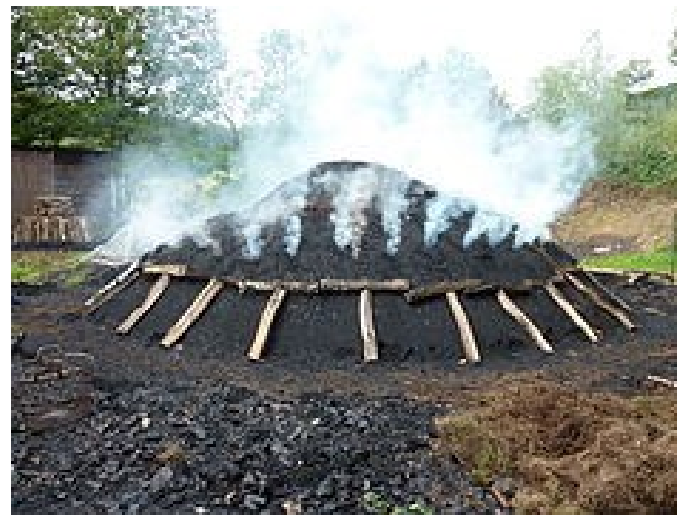
Legősibb technológia: szénégetés „boksában” 3 500 éve ismert
